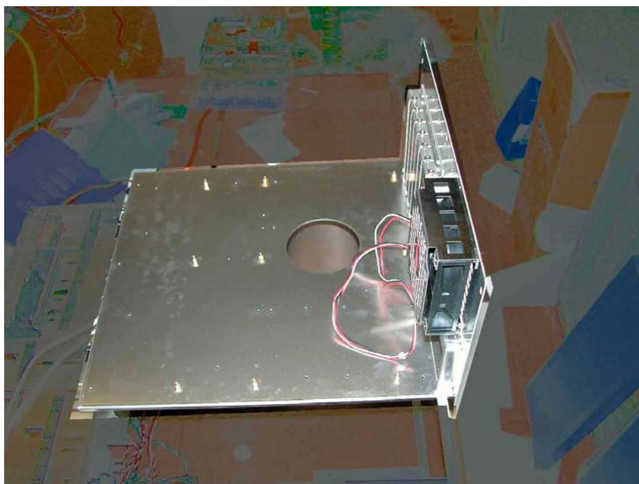
図 1 . メインボード取り付けシャーシと背面ファン
