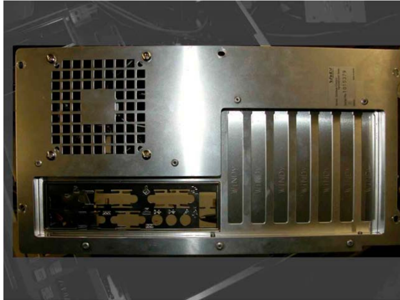
図 6 . IO シールド板をはめ込んだシャーシ背面
