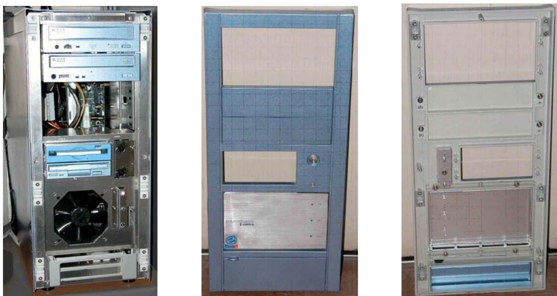
図3. フロントパネルを外した状態（左），フロントパネル表（中），同裏（右）
